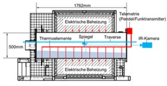
Mit einem Drehstrommelversuchsstand kann die Materialbewegung untersucht werden. Die Bewegung wird als Video aufgezeichnet. Auf fotografischen Wege wird die Materialverteilung analysiert, wie der Anteil auf jeder Hubschaufel und die Partikelanzahl in den Schleieren etc.
